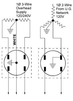
1Ø 3-Wire **LOAD 120/240V**  1Ø 2-Wire **LOAD 120**
