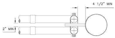
Figure 3.1b. Steel Conduit Riser, Side View
